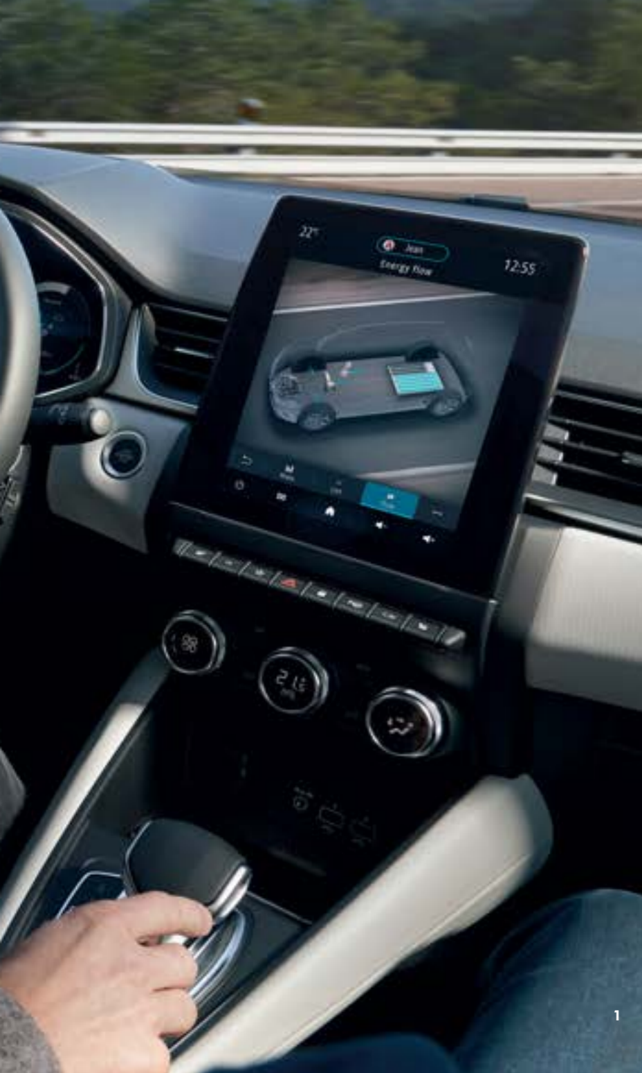
1. 9,3" mittskärm med energiflödesschema
